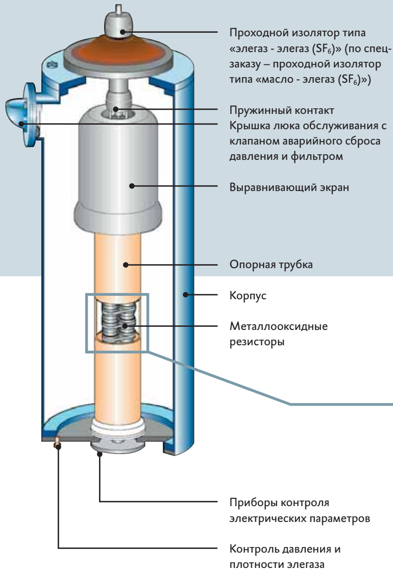
Элегазовые ОПН, подключенные к шине 420 кВ с элегазовой изоляцией
